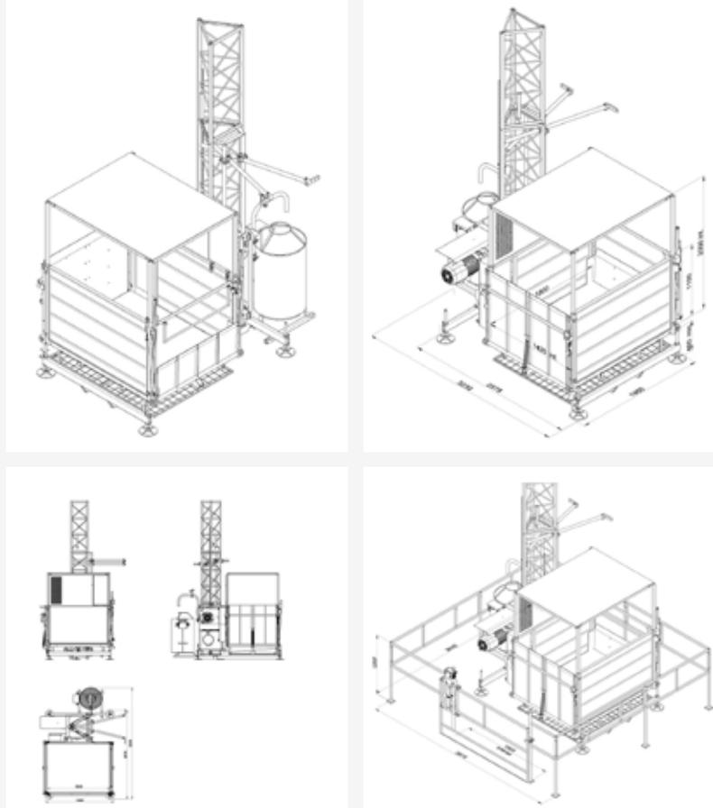
**IT - SCAF MC** è una piattaforma di trasporto di medie dimensioni flessibile e personalizzabile a seconda delle esigenze del cantiere. Disponibile in versione "standard" con rampe di accesso ed uscita, oppure su richiesta
